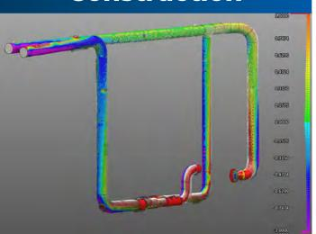
Buildit Construction è il primo strumento completamente integrato per la costruzione continua, la verifica della qualità del ciclo di vita dell'edificio e la gestione del controllo qualità. Monitora facilmente e continuamente i progetti con confronti rapidi con progetti CAD/BIM e standard regionali utilizzando dati di scansione 3D dettagliati, riducendo al minimo gli sprechi e i costosi ritardi migliorando la qualità complessiva del progetto.
